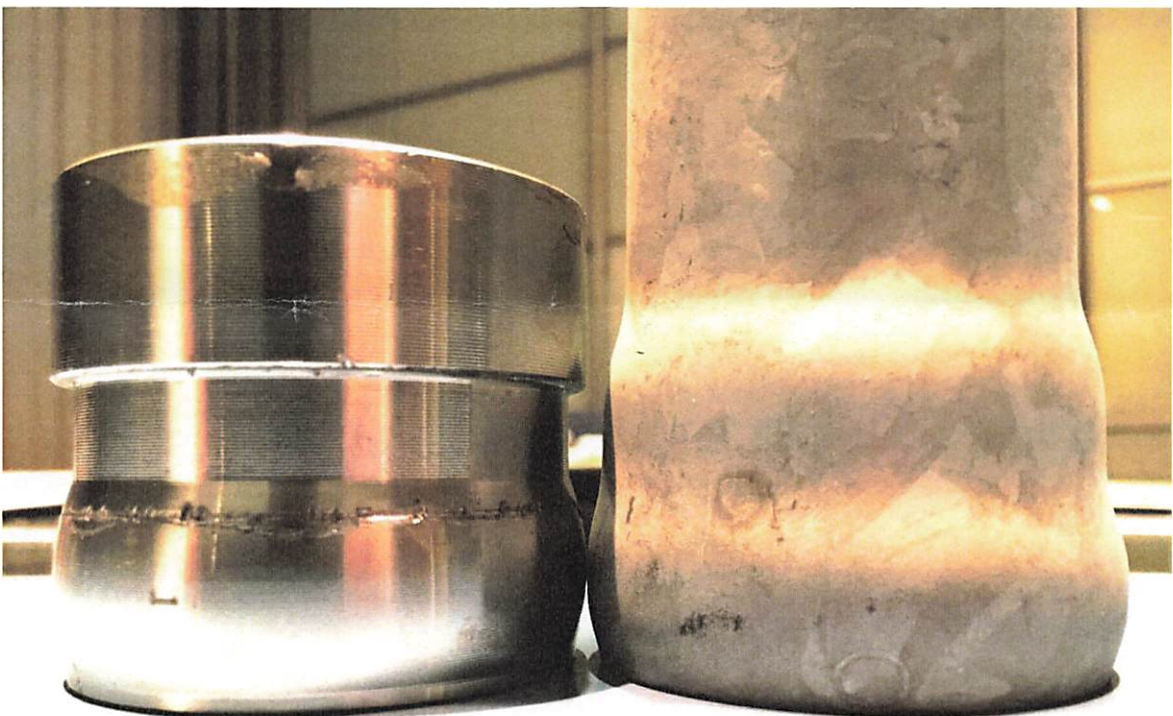
Bild, Vergleich der t_4 -Bemaßung zwischen Anschlussstück und LORO-X Rohr sowie der fehlenden Querschnittserweiterung ( t_1 )
